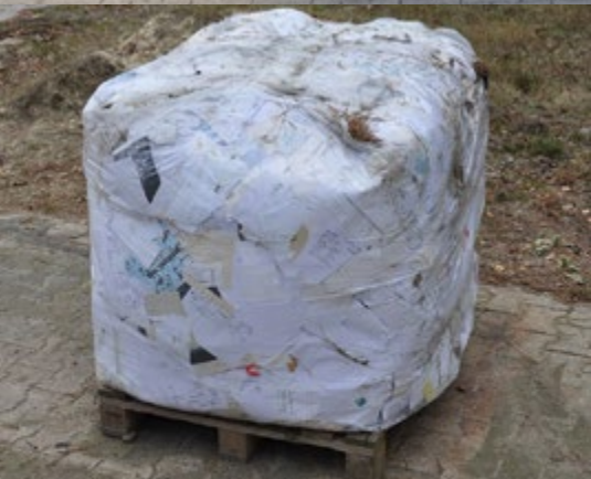
Ballen Pack-Station PS 1400-E ca. 450 kg Papier und Kartonage. Maße: ca. L 1.200 x B 1.100 x H 1.100
