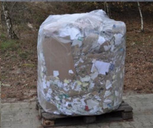
Ballen Pack-Stationen PS 8100 & PS 1000-E ca. 300 kg Papier und Kartonage. Maße: ca. L 1.100 x B 1.100 x H 1.100
